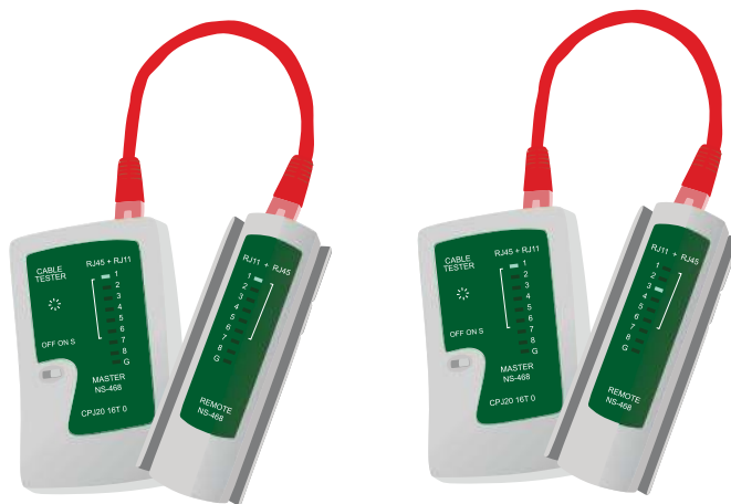
Gambar 5.14 Pengetesan Kabel LAN Straight dan Cross
